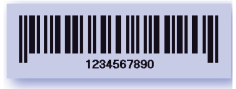
Abbildung 7: Code25 Interleaved-Strichcodes sind nicht auf eine bestimmte Anzahl von Ziffern beschränkt.
