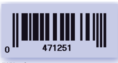
Abbildung 6: UPC-E-Code der UPC-Nummer 04710001254.
