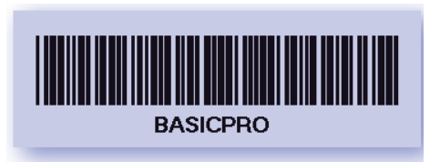
Abbildung 8: Der Code39 kann nicht nur Ziffern, sondern auch alle Buchstaben und einige Sonderzeichen darstellen.
